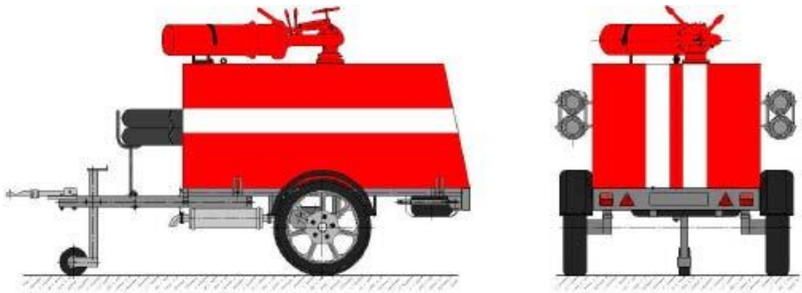
Рис. 1 Мотопомпа МП-40/100.1 Общий вид
