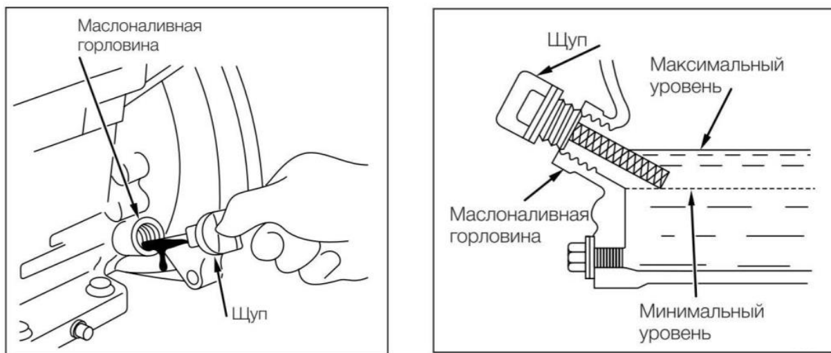
Рисунок 2.9 - Схема контроля количества масла
